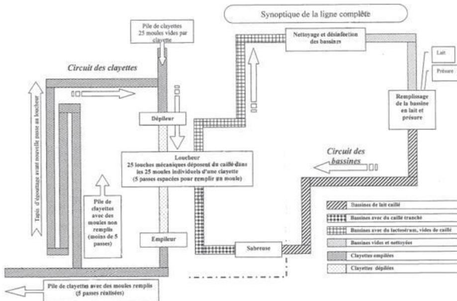
On s'intéressera plus particulièrement au système d'empilage et de transfert des clayettes.
