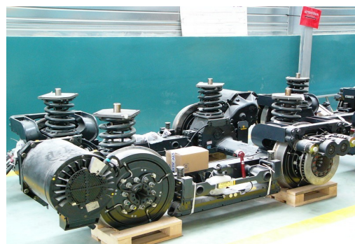
Figure 6 : bogies moteur du CITADIS
