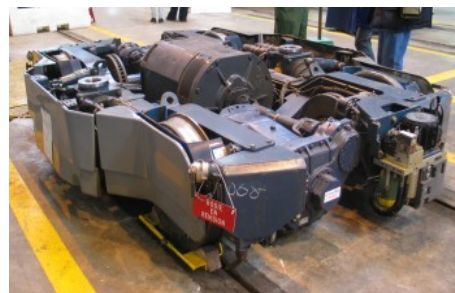
Figure 5 : bogies moteur du TFS
