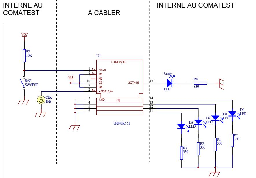
On prendra l'horloge de 1 Hz disponible sur le comatest que vous connecterez également sur une LED rouge et un bouton poussoir de RAZ. Les 4 sorties du compteur doivent être, dans un premier temps, connectées directement sur 4 LEDs rouges de la platine dont on indiquera le numéro des broches. Le poids
