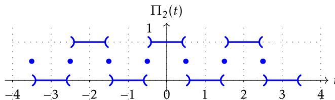
FIGURE 16 – Graphe d'un créneau de période  $T_0 = 2$ .
