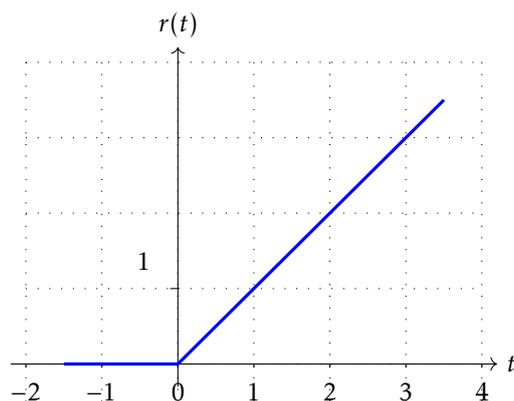
FIGURE 6 – Graphe de la rampe  $r(t)$ .
