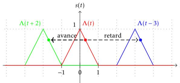
FIGURE 10 – Retard et avance sur le signal triangle.
