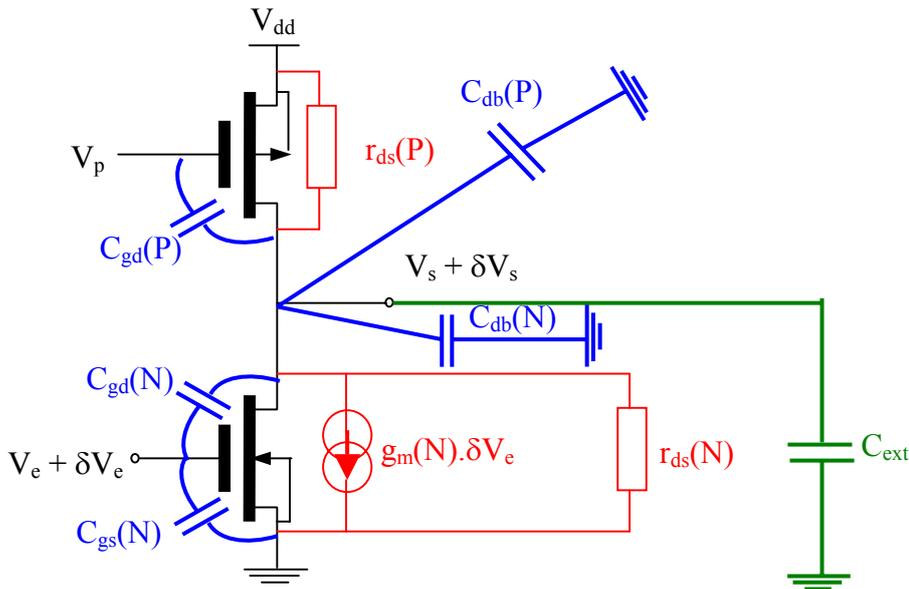
En se basant sur le montage ci-dessus qui recense tous les éléments parasites et/ou extérieurs au montage, on peut établir le schéma petit signal de l'ampli 1 étage.
