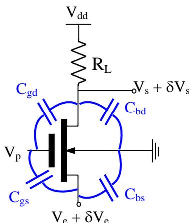
La capacité d'entrée //  $r_e$  est  $C_e = C_{gs} + C_{bs}$
