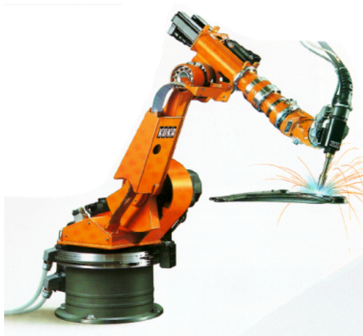
FIG. 3 – (a) Un asservissement angulaire efficace donne aux bras robotiques KUKA une répétabilité de l'ordre du dixième de mm!
